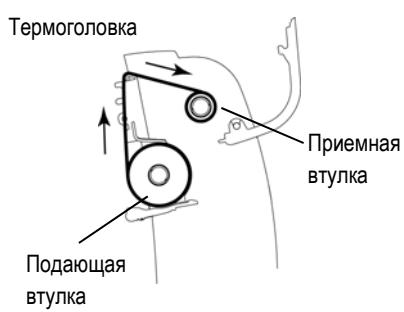
5. Прокручивайте шестерню перемотки ленты до тех пор, пока красящая лента не намотается на приемную втулку и не покроет печатную термоголовку, а также устраните провисание ленты.
