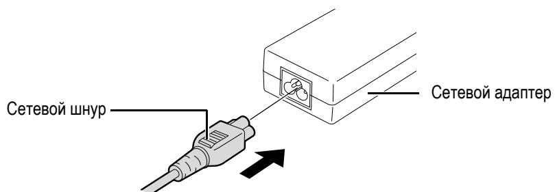
3. Вставьте кабель от сетевого адаптера в разъем кабеля питания на задней поверхности принтера.
