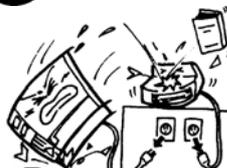
Si se caen las máquinas o se estropean sus cajas, apague primero las máquinas, desconecte las clavijas de alimentación de la toma de corriente y póngase en contacto con su Distribuidor Autorizado TOSHIBA TEC para que le proporcione asistencia. La utilización continua de las máquinas bajo estas condiciones puede causar un **incendio** o una **sacudida eléctrica**.
