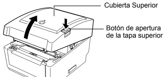
La tapa no se cierra por su propio peso, ya que está sujeta por un amortiguador.
