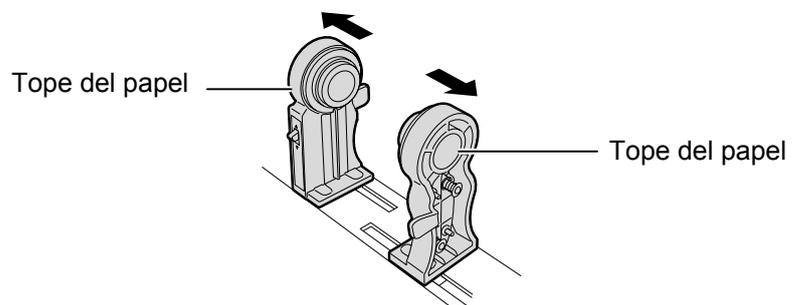
4. Coloque el rollo entre los ejes de papel de forma que, al avanzar, la cara de impresión quede hacia arriba. Ajuste las salientes de los ejes dentro del mandril del rollo. Asegúrese que las salientes de ambos lados quedan encajadas firmemente en el mandril del rollo.
