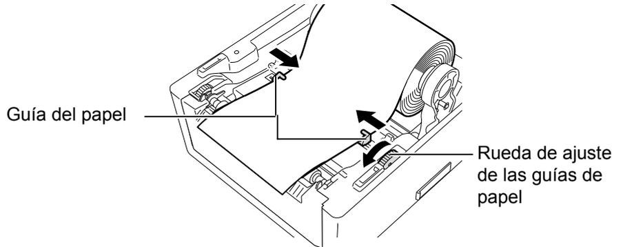
8. Presione los ejes de papel contra el rollo hasta sujetarlo firmemente, luego mueva la palanca de bloqueo de los ejes de papel a la posición (▼).
