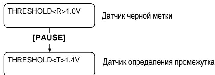
(4) Установите пороговое напряжение, посчитанное в меню регулировки датчиков, используя кнопки [FEED] или [RESTART], как показано ниже.
